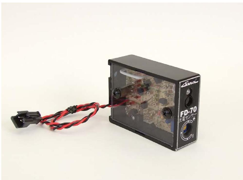
FD-70型センサーはパチスロ機の前面扉(ドア)の開閉状態を検知するセンサーです。本センサーをナンバーランプや自動追尾式監視カメラ、或は管理用モニター等と接続することにより、ドアの閉め忘れや営業中の遊技機の点検、不正目的によるドアの開放など、営業上トラブルの原因となりやすい遊技機前面扉の開閉を素早く確認することができます。
