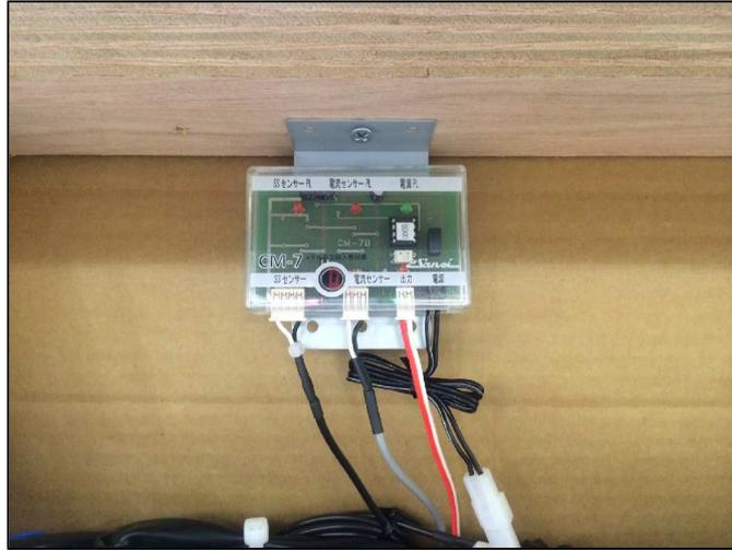
2. CM - 7型 電流センサーとSSセンサー取り付け参考写真
