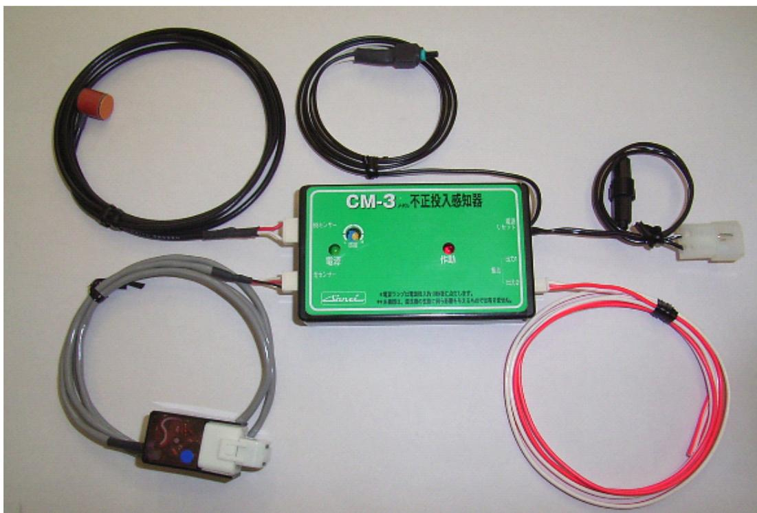
CM-3型は正規のメダルを使用せず特殊な器具を用いてパチスロ機を誤動作させる不正を素早く感知し、接続されたナンバーランプの不正表示や不正告知用の個別ランプ、或いは監視カメラの自動追尾を駆動することができます。本器はパチスロ遊技機の投入口より投入されたメダルを、専用部品で1枚1枚チェックをします。従って、不正用特殊器具の機能が変更されても充分対応可能です。従来の作動時間比較タイプの感知器とは性能に格段の開きがあります。
