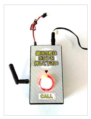
(2)送信機(WS-1A)のボタンが押下されるとほぼ同時に受信機(WS-1B)の作動ランプが点灯し、 受信機に接続されたLED回転灯が点灯します。(接点出力も同時にONになります)
